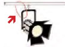
**Equipotential bonding for metal constructions**
